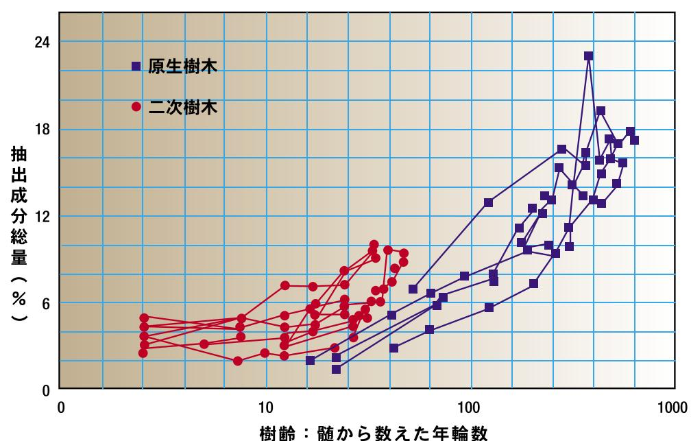
熱水抽出成分は容易に水蒸気蒸留法によって揮発性(芯材の1.0 ~ 1.5%)および不揮発性留分(5~15%)に分離することができま(Barton and MacDonald 1971)。揮発留分は主にツヤプリシン、ツヤ酸(thujic acid)、およびメチルエステルから成っています。ツヤプリシンは特に優れた天然の殺菌力を持っており、ツヤ酸もそれに次ぐ殺菌効果を備えています。ツヤプリシンは木材腐朽菌に対して高い毒性作用を発揮します。ツヤプリシンの毒性はペンタクロロフェノールナトリウム(sodium pentachlorophenate)と同程度です(Barton and MacDonald 1971)。ツヤ酸メチルはウェスタンレッドシダー独特の芳香を形成している成分で、ヒメマルカツオブシムシおよび繭を作る衣蛾に対して毒性をある程度持っています(Barton 1962)。このため、ウェスタンレッドシダーはブランケットチェストの内張りに最適な素材としてよく使われます。
