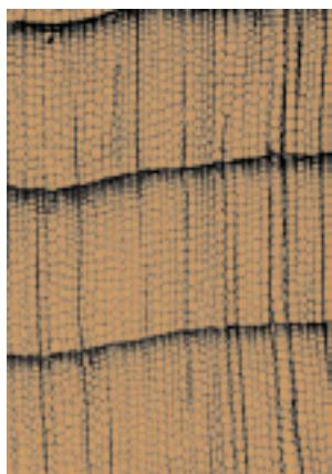
仮道管は長さ平均3.5mm (1.4~5.9mm)の纖維を持ち、軸方向の幅は平均30~45μm (Isenberg 1980)です。WellwoodとJuratz (1968)によると、髓付近の仮道管は短く(1.2mm)、50年生で3.5mmに達し、その後は何年でも成長するに従ってゆっくりと増加します。纖維の長さは切株高で最低となり、中間の高さで最高となり、その後は樹高が高くなつても感知できるほど増加しません。切株と10年生以下のサンプルを除外した場合、纖維の長さ相加平均3.3mmが得られ、全てのサンプルを計算に入れると2.3mmとなります。GraffとIsenberg (1950)はクラフトパルプの纖維長は平均でそれより短い2.05mmで、最も考えられる原因は切断であろうと報告しています。
